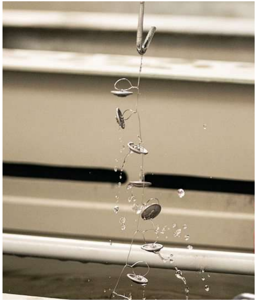
Attachés à un fil, les boutons sont trempés pour être plaqués grâce à un système d'électrolyse qui décidera de leur fini mat, brillant, satin ou velours.
