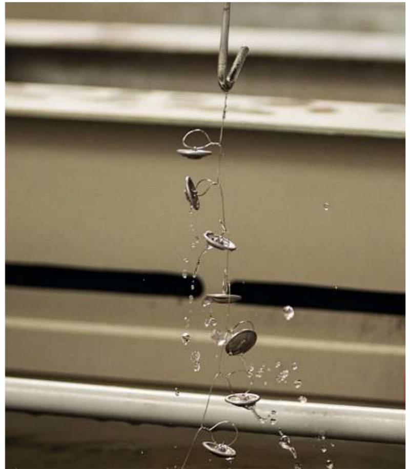
Die an einem Draht befestigten Knöpfe werden gehärtet, um dann mithilfe eines Elektrolysesystems plattiert zu werden. Mit dem System kann man die Oberfläche matt, glänzend, satiniert oder samtig gestalten.
